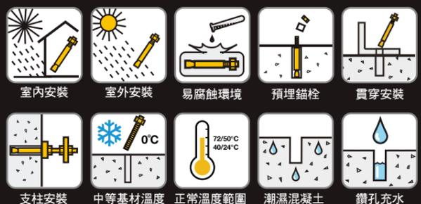
支柱安裝 中等基材溫度 正常溫度範圍 潮濕混凝土 鑽孔充水
